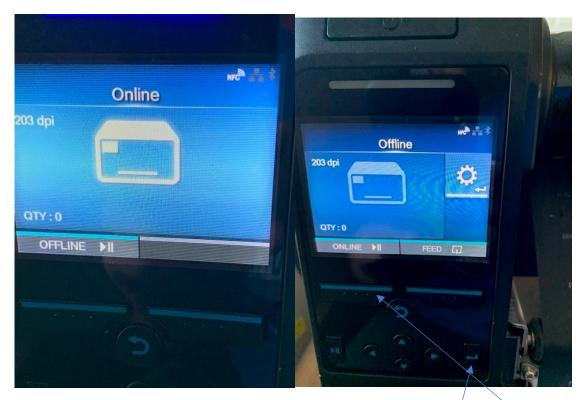
TAKE THE PRINTER OFFLINE BY PRESSING THIS BUTTON USING THE ENTER BUTTON ENTER THE SETTINGS
