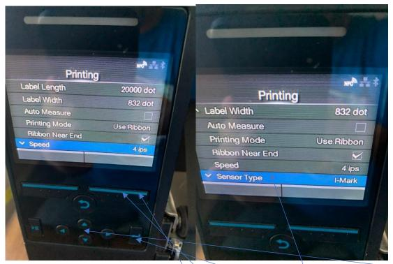
SCROLL THROUGH THE MENU USING THE UP OR DOWN ERROR BUTTONS
