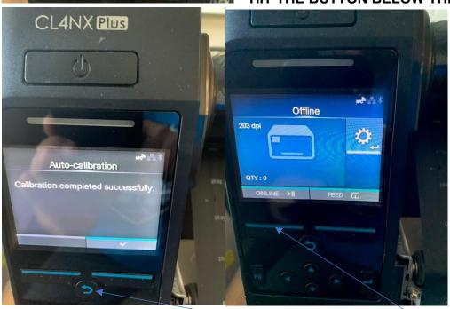
AFTER THE CALIBRATION HAS COMPLETED SUCCESSFULLY USE THE U-TURN BUTTON TO BACK OUT TO THE BEGINNING SCREEN
